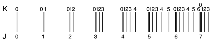
Abb. 8.3: Schematische Darstellung des Rotationsspektrums eines symmetrischen Kreisel-Moleküls [8.4].
